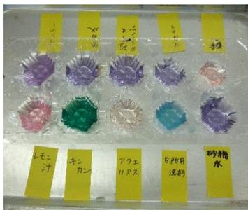
より多くの水溶液を効率的に実験できるように、卵パックを試験管の代わりに使用する。
